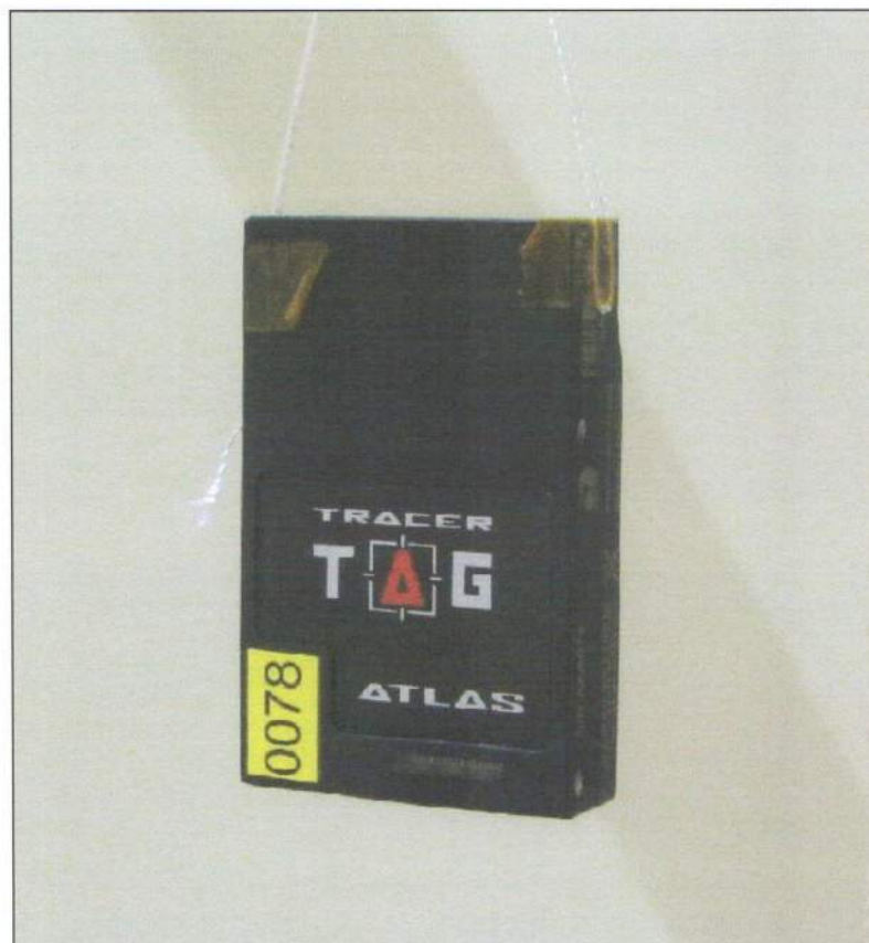
FOTO 10 - Detalhe da forma de fixação do cordão de suspensão/içamento no corpo da amostra de teste (Ref.: Impacto sobre Face).
