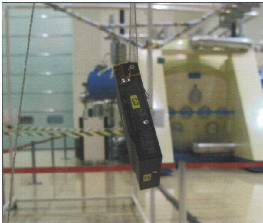
FOTO 13 - Vista geral da amostra posicionada para a Queda #24 (no caso, impacto sobre o canto 1-4-6).
