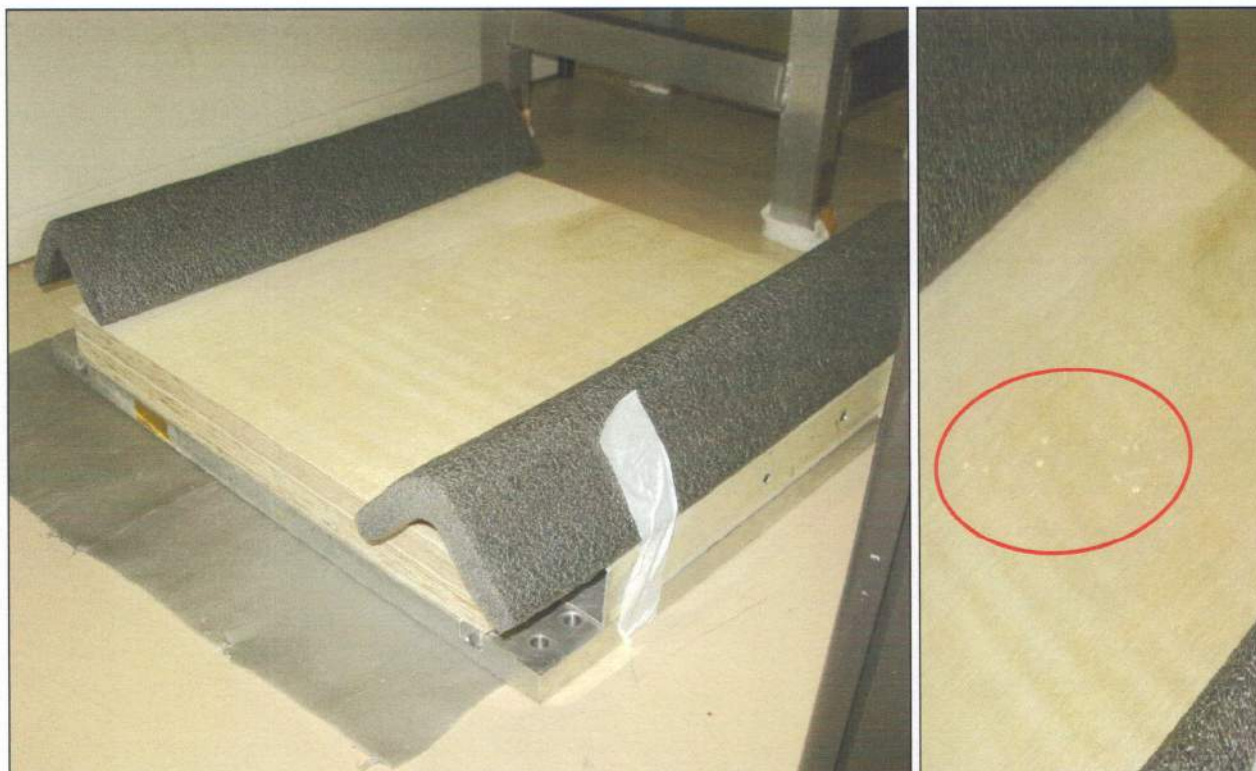
FOTO 16 - Vista geral da placa de compensado naval após os ensaios de queda livre e detalhe da região de impacto da amostra de teste (pequenas perfurações na superfície).
