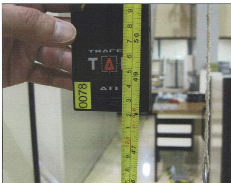
FOTO 08 - Detalhe do ajuste da altura de queda ( h = 1,22 m em relação à superfície da placa de madeira).
