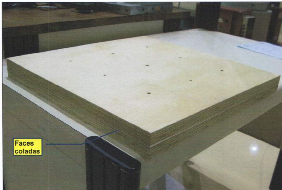
FOTO 04 - Vista geral da placa de compensado naval (duas placas unidas por parafusos e cola) utilizada nos ensaios de queda livre do Rastreador CARGO.
