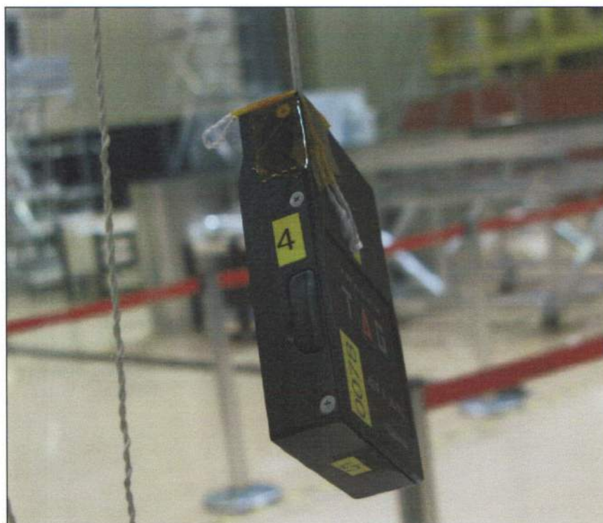
FOTO 14 - Detalhe da forma de fixação do cordão de suspensão/çamento no corpo da amostra de teste (Ref.: Impacto sobre canto).
