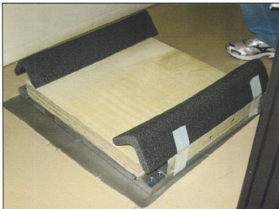
FOTO 06 - Detalhe da proteção com cantoneiras de poliestireno colocadas sobre as regiões contendo acessórios de fixação da placa de compensado naval.
