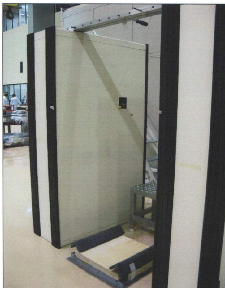
FOTO 07 - Vista geral do setup de testes utilizado para os ensaios de queda livre do Rastreador CARGO.
